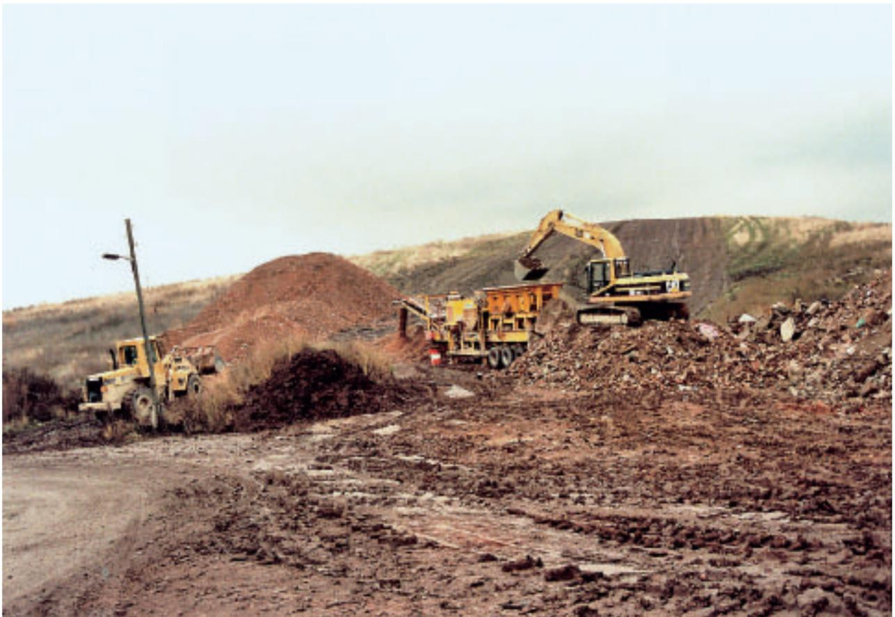
Abb. 25: Bauschutttaufbereitung auf der Deponie Rehestadt
