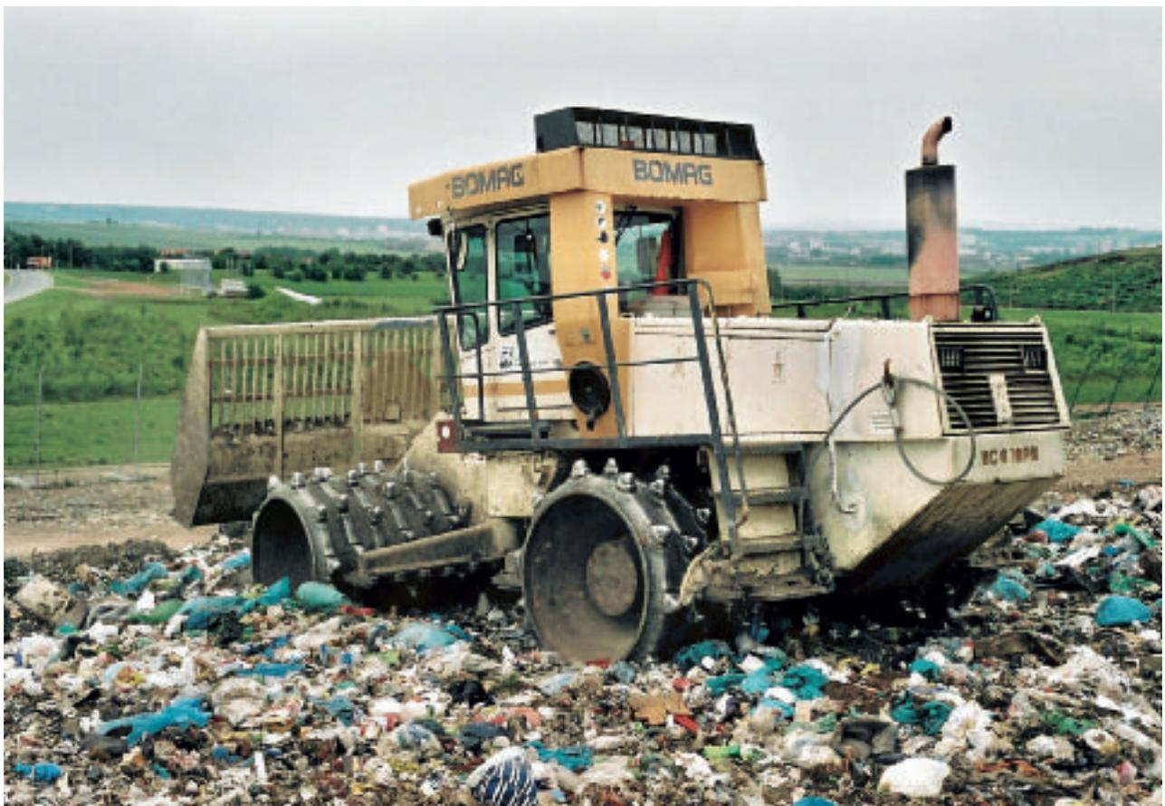
Abb. 27: ... und anschließender verdichteter Einbau auf der Deponie Schwerborn
