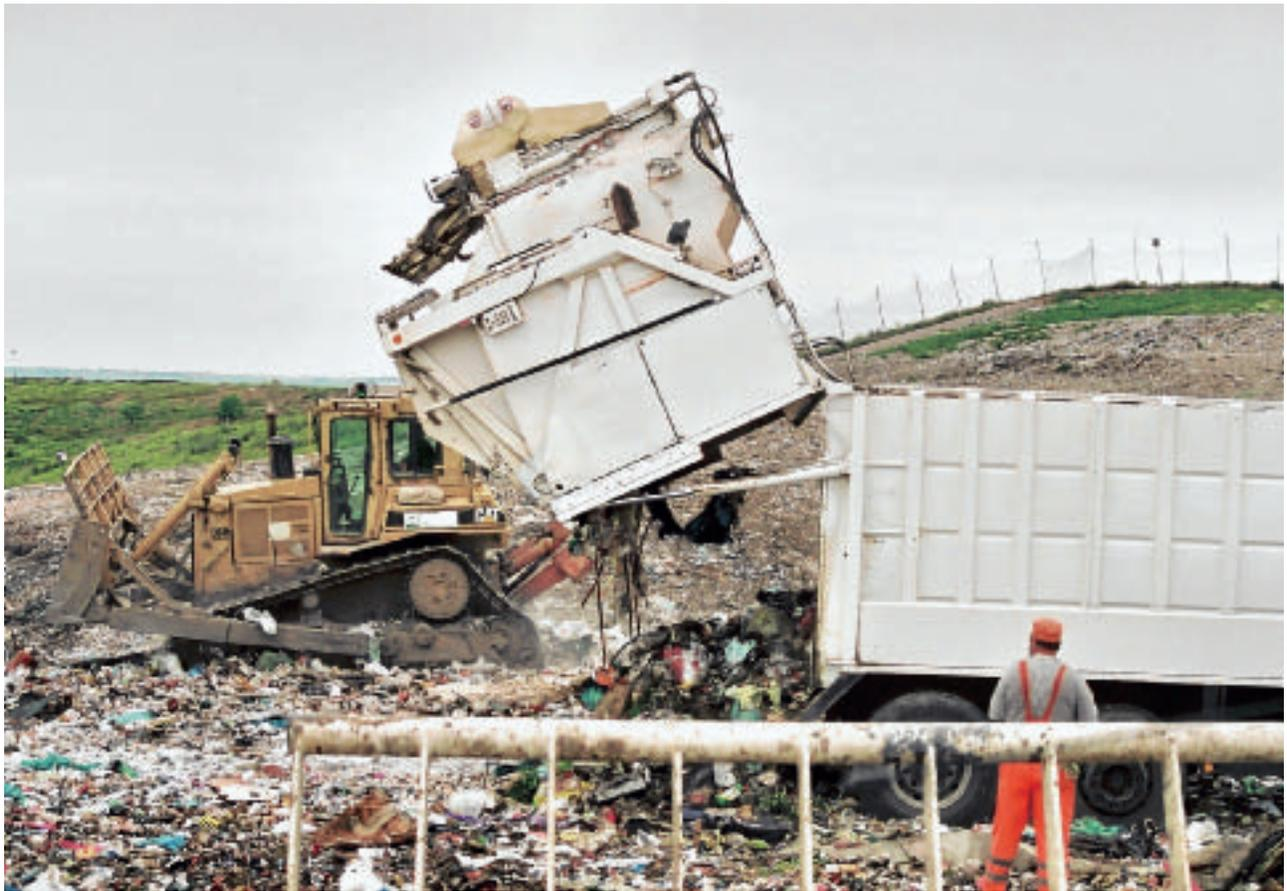
Abb. 26: Abladen und Verteilen von Sperrmüll ...
